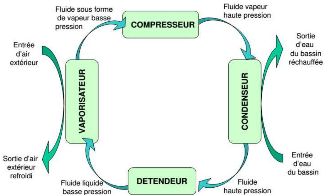
Figure 2. Cycle du fluide frigorigène dans la PAC
